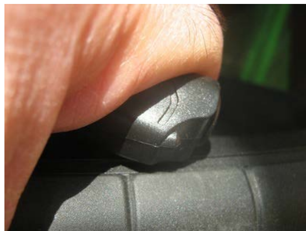
Фиг. 1 Микрофонът (горе) на дръжката на косата (долу).
