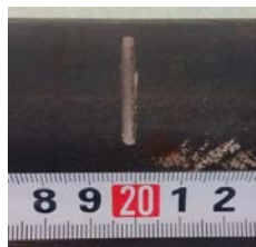
Фиг. 9 Напречен срез, имитиращ напречна пукнатина в безшевна тръба с диаметър 89 mm
