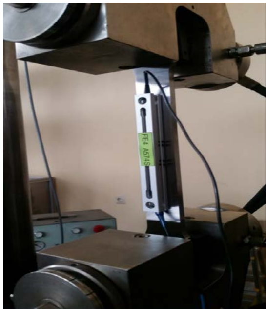
Снимка 2. Механично натоварване- опън на образец FE4 и измерване на времето на преминаване на повърхностните вълни в обхват от натоварвания 50 MPa, 100 MPa, 150 MPa, 200 MPa, 250 MPa и 300 MPa.
