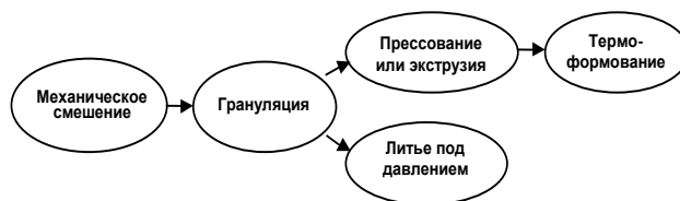
Фиг. 2. Схема технологических операций производства конструктивных РПМ.
