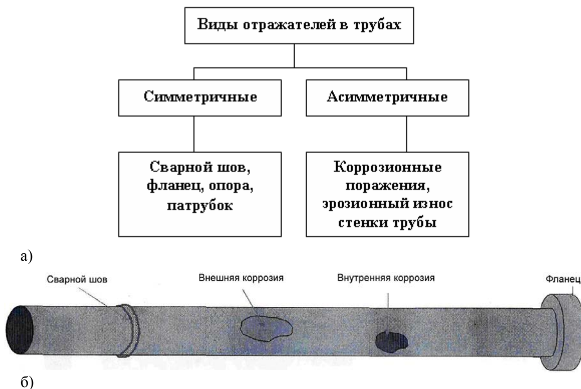
Рис. 3. Классификация видов отражателей в трубопроводе (а) и схема их возможного размещения на трубе (б)
