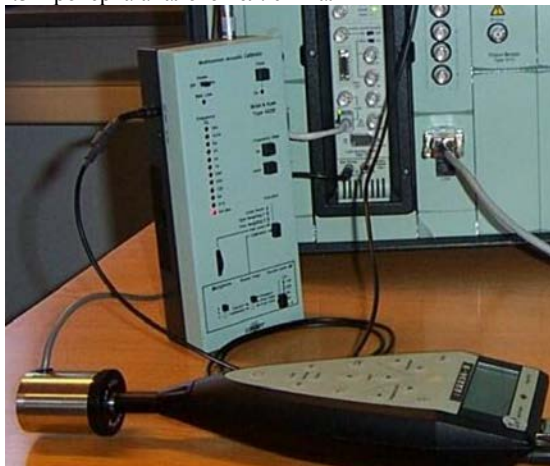
Фиг.4 Автоматично акустично калибриране – шумомер 2238
