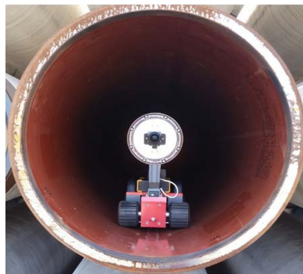
Снимка 4. Видеосистема-кролер за визуален контрол на тръбопроводи „Каросел 813“
