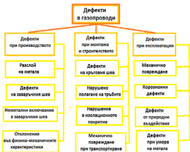
Фигура 1. Видове дефекти в газопроводи.
