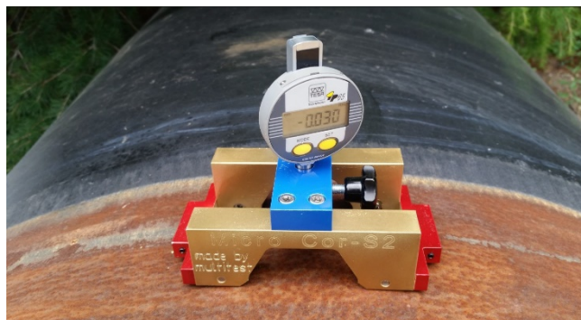
Снимка 3. Механизирана система за измерване дълбочина на питинг корозия на тръбопроводи- модел „Micro Cor S2“
